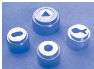
(Boven) Verschillende opzetstukken voor de matrijs van de extrusiemachine. De vorm van de matrijs bepaalt de vorm van de droge brokjes. De hier getoonde opzetstukken produceren ovale, ronde, driehoekige en visvormige stukjes.
